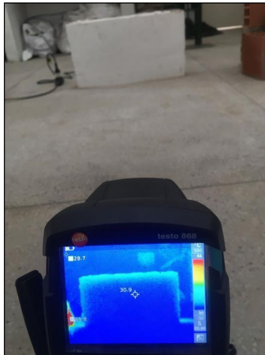
Figura 28 Medição de temperatura com a câmera térmica.
