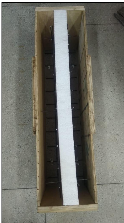
Figura 19 Vista Superior fôrma devidamente posicionada para concretagem do protótipo da parede sanduíche com núcleo em EPS.
