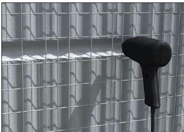
Figura 8 Aberturas de canais com soprador térmico.
