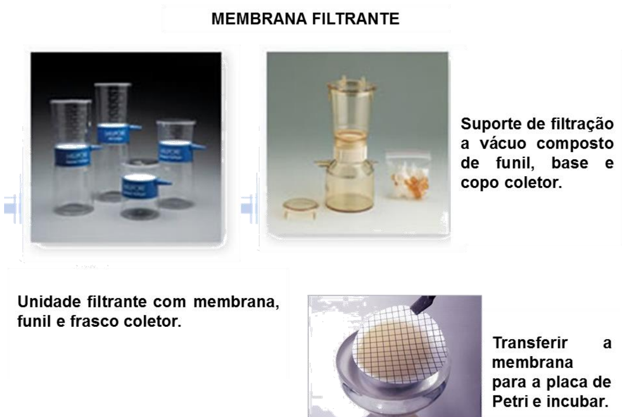
Figura 06: Técnica de Filtração em Membrana
