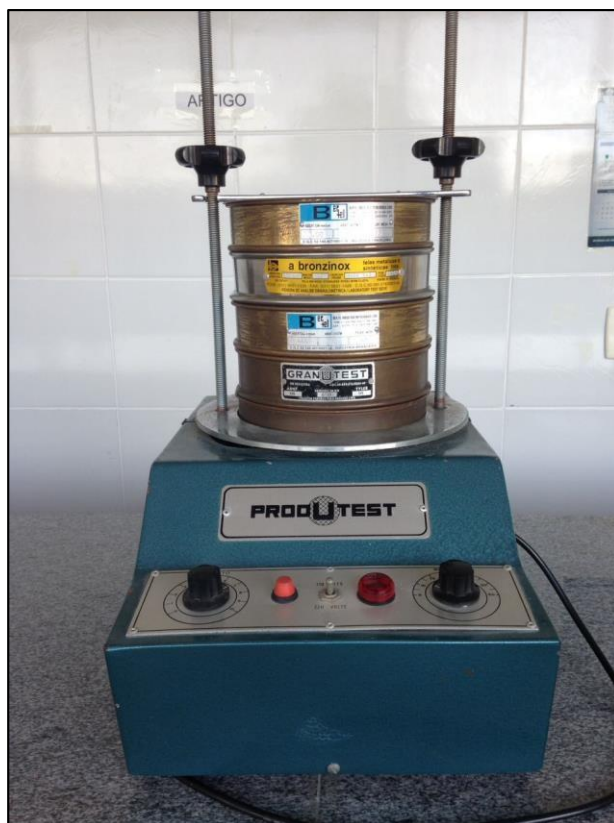
Figura 9: Agitador eletromagnético com a série de peneiras utilizadas para o peneiramento seco
