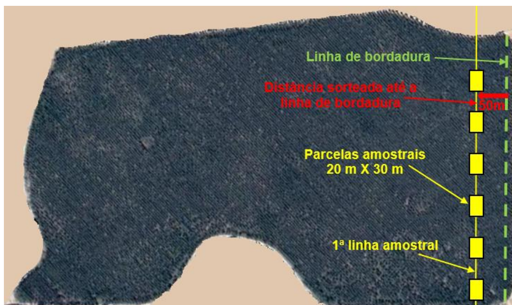
FIGURA 29 Amostragem sistemática com um só início aleatório
