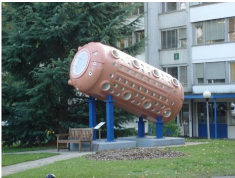
Gargamela ; detector do tipo câmara de bolha destinado à detecção de neutrinos. Foi construída na França com 2 m de diâmetro e 4,8 de comprimento, era cheia com 12\text{m}^3 de gás freon ( \text{CF}_3\text{Br} ). Foi utilizada no CERN entre 1970 e 1978. Foi nela que teve lugar uma das primeiras grandes descobertas realizadas no CERN; a observação da força nuclear fraca em 1973 pouco depois de sua predição teórica indispensável para a unificação do modelo padrão.
