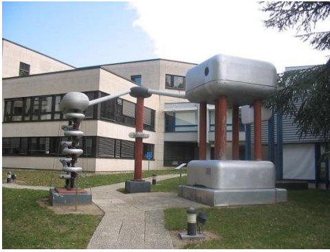
Acelerador de partículas fabricado pela Philips-Eindhoven em 1937 para pesquisa.
