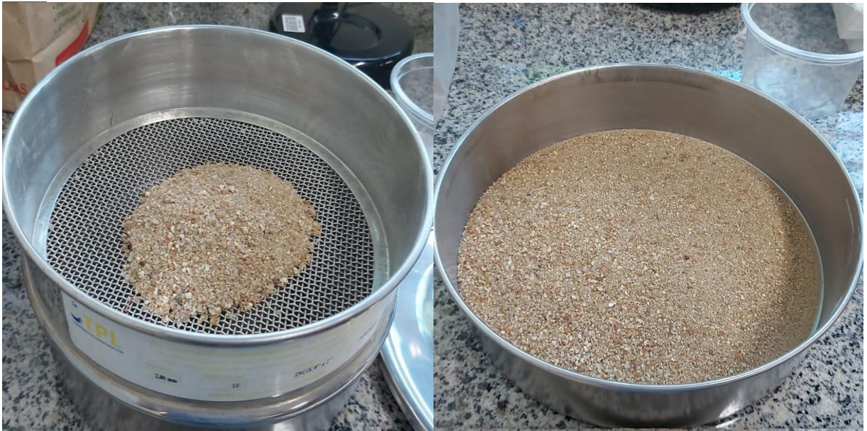
Figura 3.10 - Retirada da matéria orgânica e cascalho por peneiramento.
