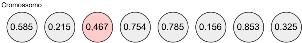
Figura 3.10: Exemplo de mutação do cromossomo aleatório gerado pelo BRKGA. Fonte: Autor, 2025.
