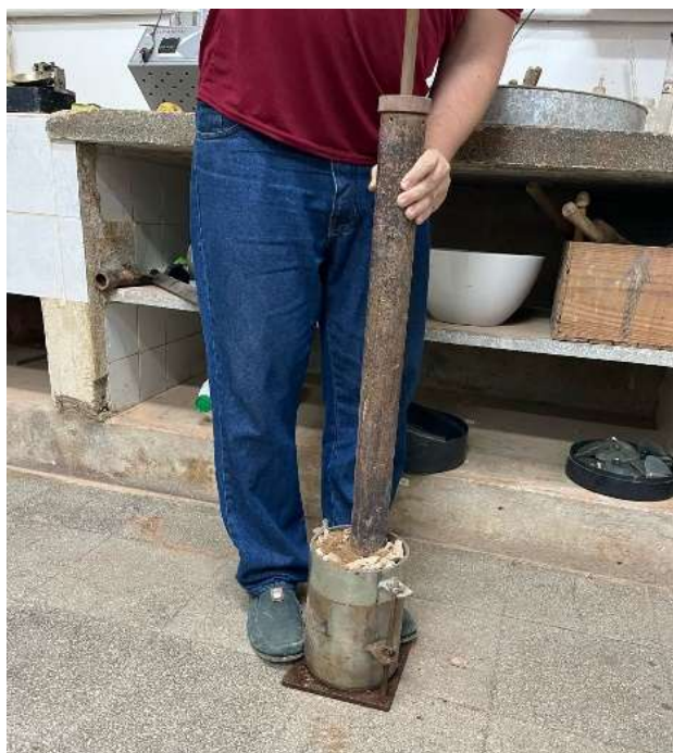
Figura 19 – Execução do ensaio de compactação
