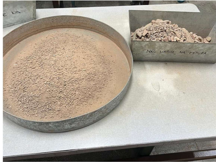
Figura 9 – Ensaio de granulometria do AR
