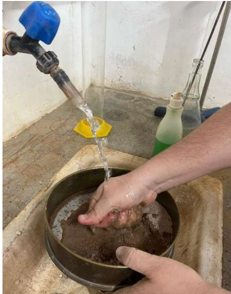
Figura 12 – Lavagem do peneiramento fino do AR
