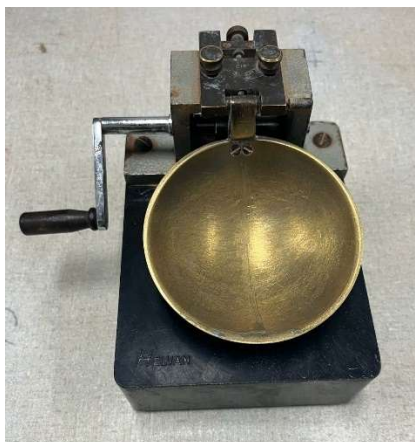
Figura 16 – Aparelho de Casagrande
