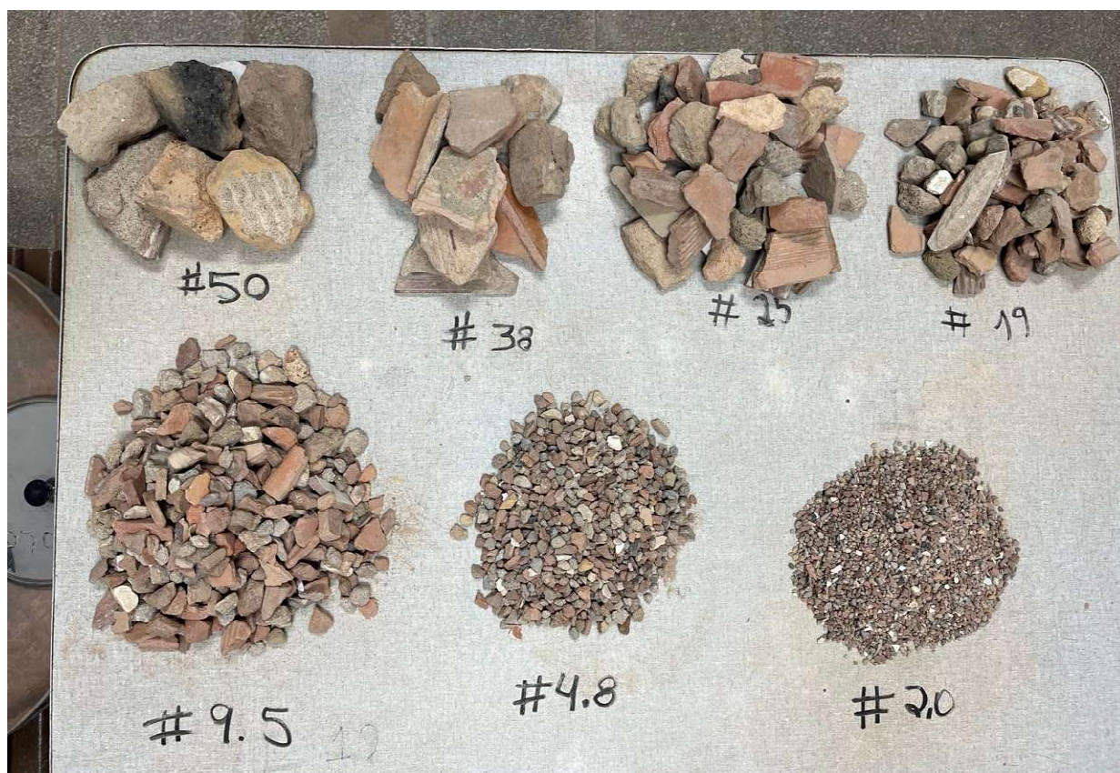
Figura 11– Amostras do AR após peneiramentos grosso
