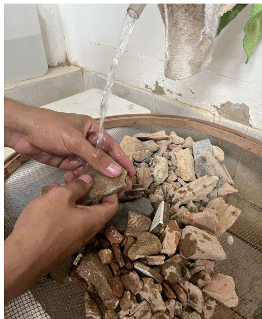
Figura 10 – Lavagem do peneiramento grosso do AR
