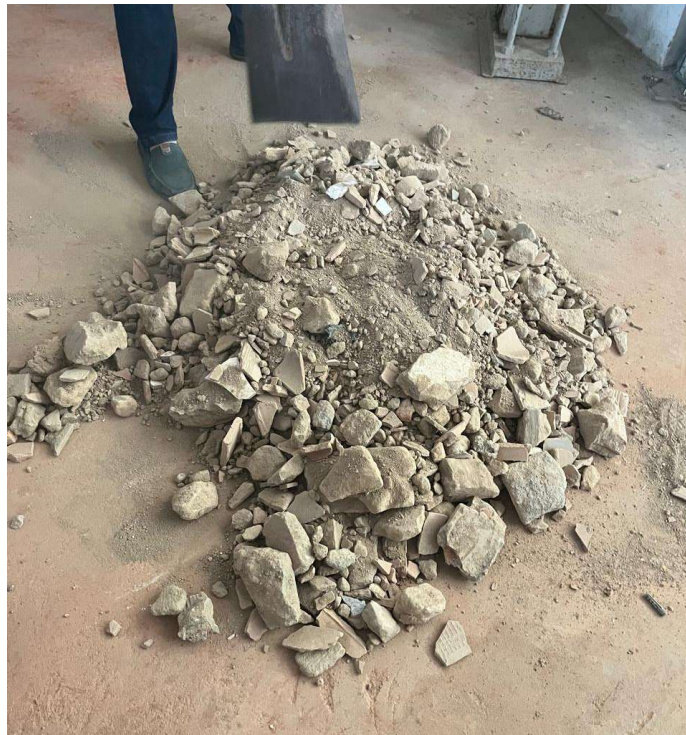
Figura 23 – Agregado reciclado utilizado no estudo
