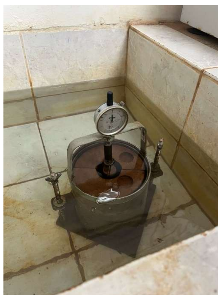
Figura 21 – Corpo de prova imerso
