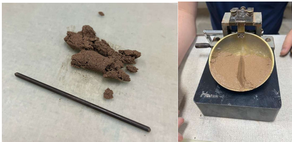
Figura 28 – Resultado do ensaio de Limite de Plasticidade e Limite de Liquidez
