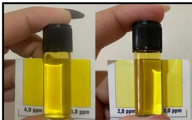
Figura 14 - Primeiras amostras de fitoplânctons sendo comparada com a escala de cores de OD.
