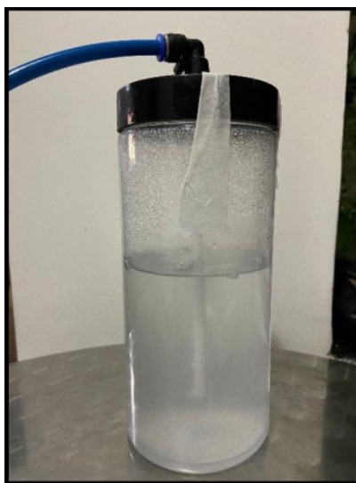
Figura 4 - Sistema de Aeração com a água salgada antes da inoculação
