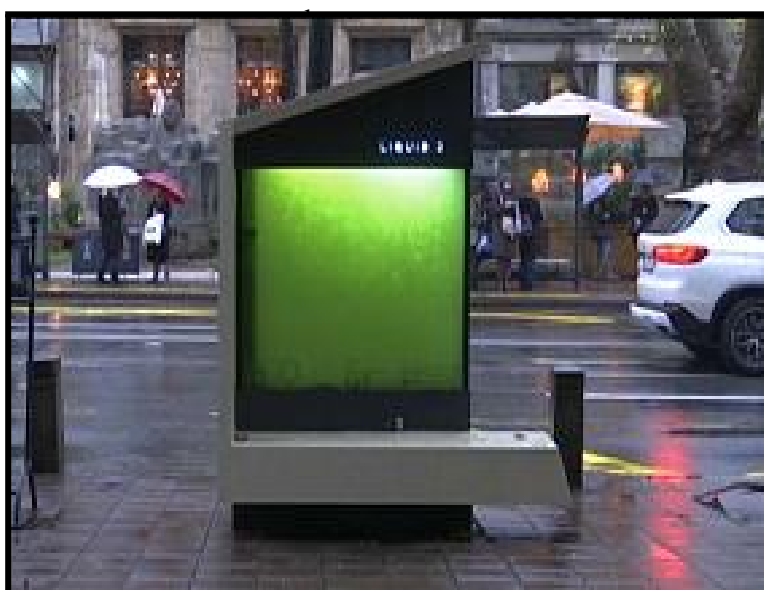
Figura 2 - Árvore líquida localizada na cidade de Belgrado na Sérvia - primeiro fotobiorreator
