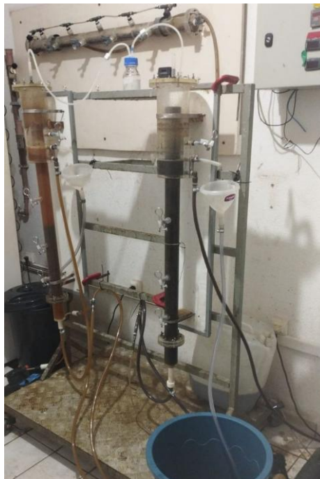
Figura 8: Reatores anaeróbios de leito fluidificado ( RALF_1 e RALF_2 ) em operação.
