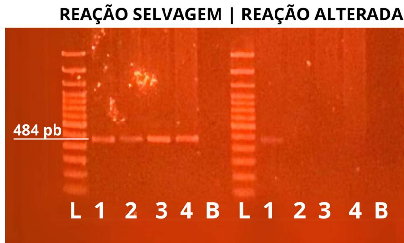
Figura 29. Eletroforese em gel de agarose para verificação da presença/ausência do alelo selvagem e do alelo com a VPG c.1687C>T (p.Gln563*) no gene BRCAL .
