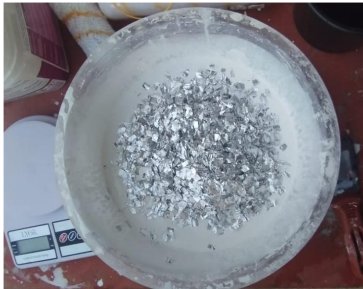
Figura 3.11: Mistura da tinta enriquecida
