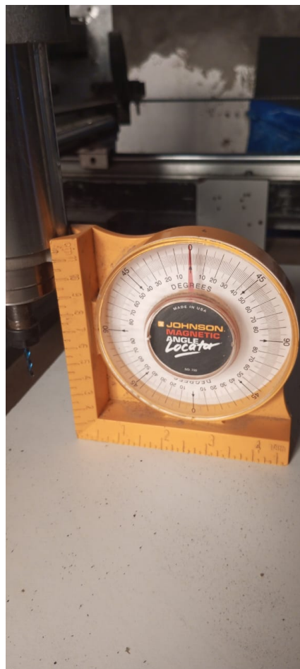
Figura 4.4: Verificação do esquadro do eixo Z
