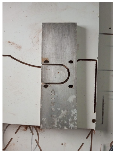
Figura 4.9: Cortes em alumínio
