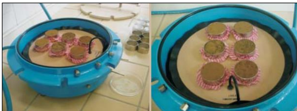
Figura 12: Amostras sobre a membrana conectada ao dreno da câmara de pressão Fonte: Embrapa, 2007
