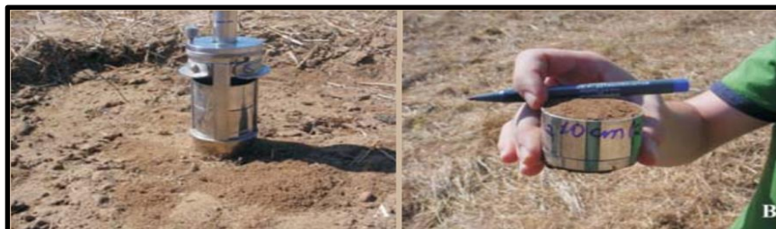
Figura 10: Procedimento de coleta da amostra indeformada Fonte: Embrapa,2007
