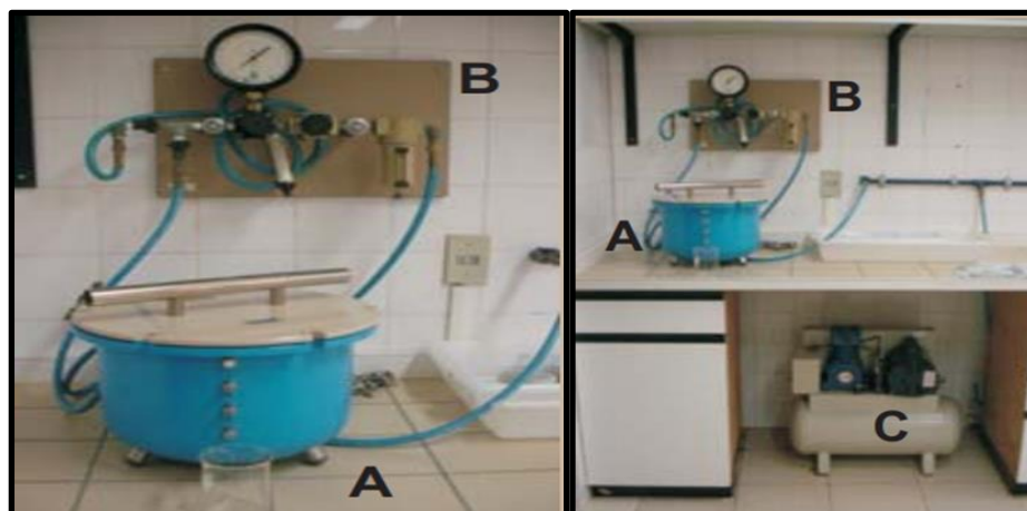
Figura 9: Câmara de pressão de Richard (A B C) Fonte: Embrapa, 2007
