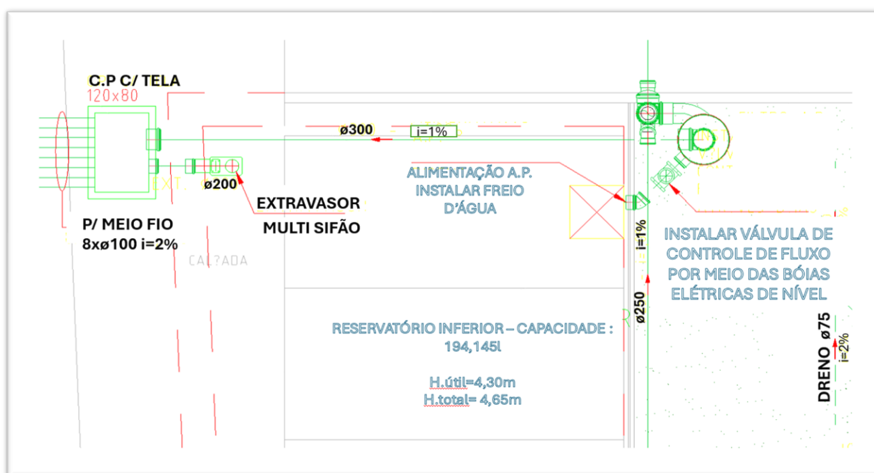
Figura 20: Válvula de controle e extravasor multi sifão Fonte: Adaptado de SEDET, 2018
