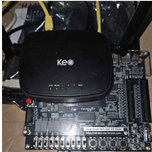
Figura 3.1: Conjunto DE1-SoC ligado ao roteador KLR 300N
