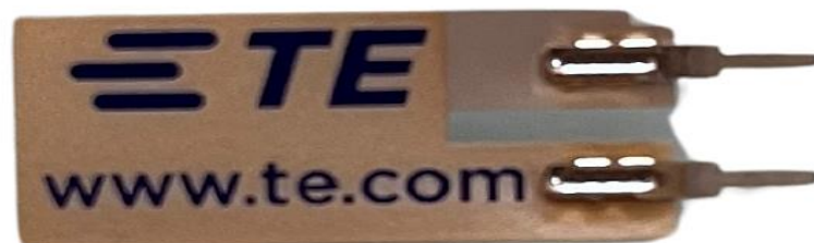
Figura 17 - Modelo de pastilha piezoelétrica utilizada nos ensaios
