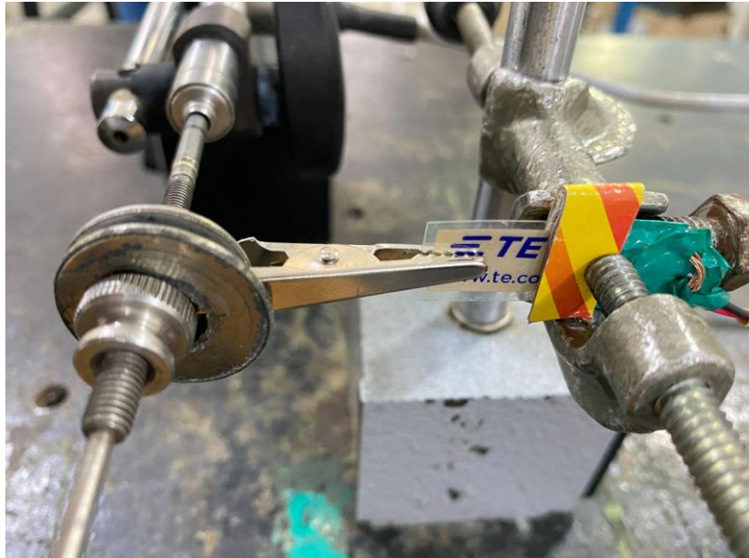
Figura 20 - Pastilha PZT engastada na haste e no suporte
