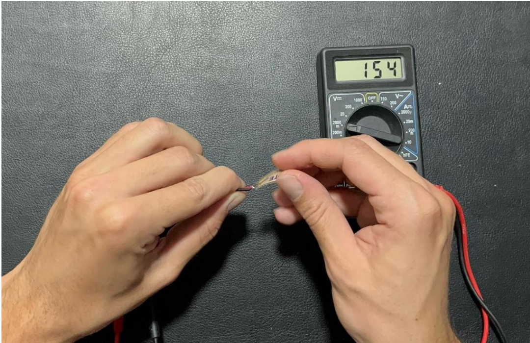
Figura 22 - Multímetro medindo os pulsos elétrico da pastilha PZT
