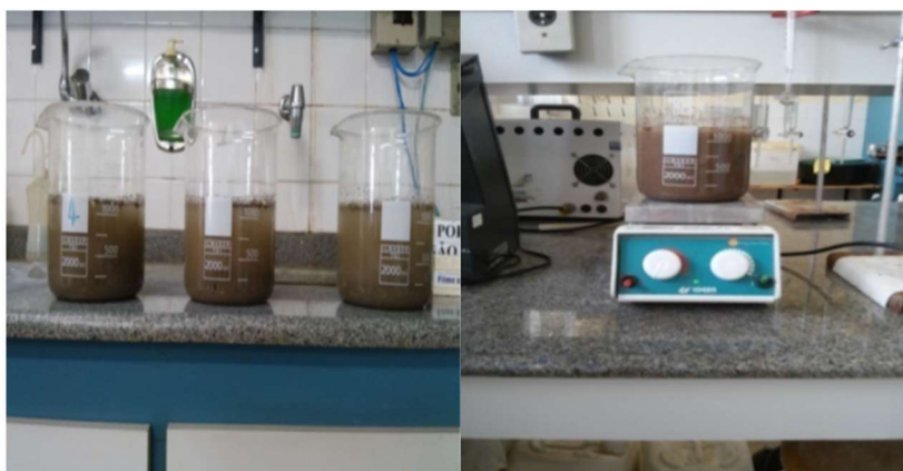
Figura 29: Ensaio de solubilização
