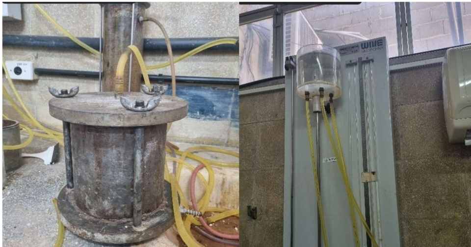
Figura 14: Ensaio de permeabilidade.
