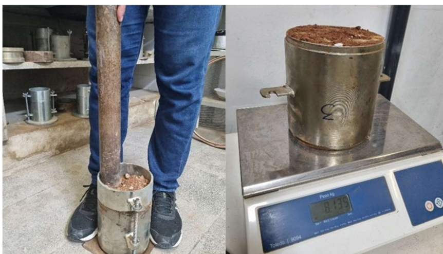
Figura 13: Ensaio de compactação.
