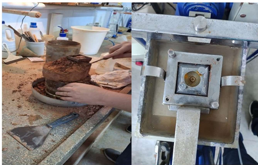
Figura 24: Moldagem e saturação das amostras para ensaio de cisalhamento.
