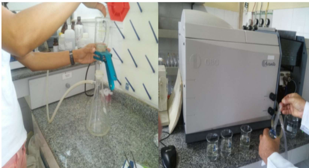
Figura 30: Filtração e leitura das amostras em espectrofotômetro
