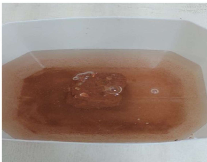
Figura 21: Ensaio de desagregação com amostra totalmente submersa.
