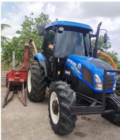
Figura 6 – Trator com siladeira.
