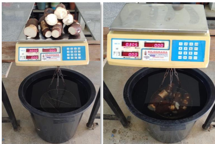
Figura 7. Pesagem de 3 kg de raízes de macaxeira, pelo método da balança hidrostática, para determinação da matéria seca.
