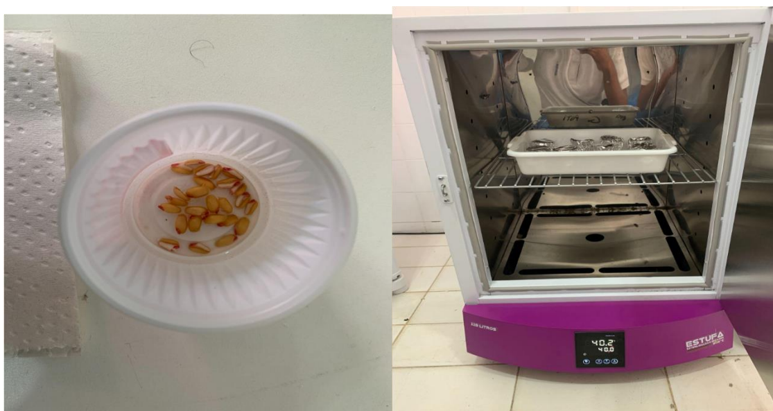
FIGURA 1 - Imersão das sementes na solução de tetrazólio e coladas em estufa de circulação fechada por duas horas a uma temperatura de 40°C.
