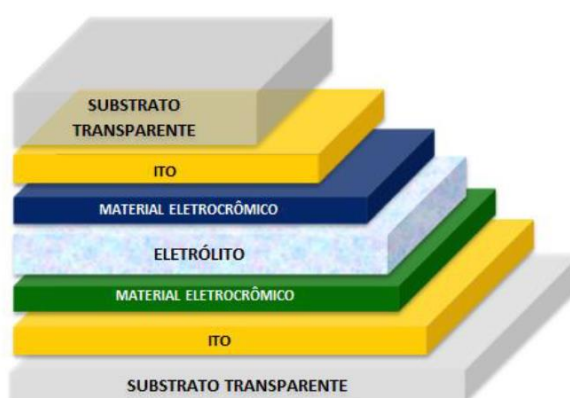
Figura 18 - Representação das camadas constituídas de um dispositivo eletrôcrômico
