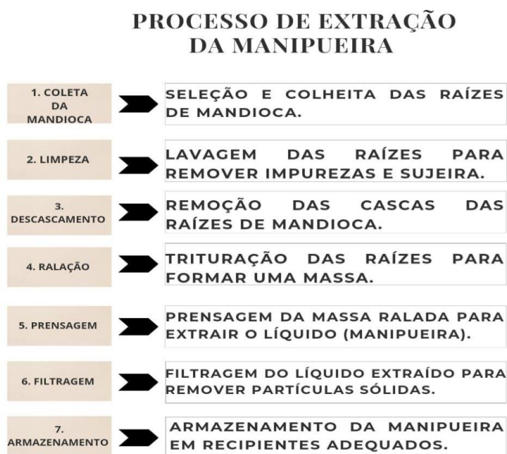
Figura 1. Diagrama do processo de extração da manipueira. Fonte: Autor, 2024.
