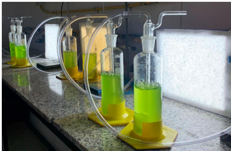
Figura 10 - Sistema de tratamento de soro do leite em um reator coluna de bolhas com intensidade luminosa constante.
