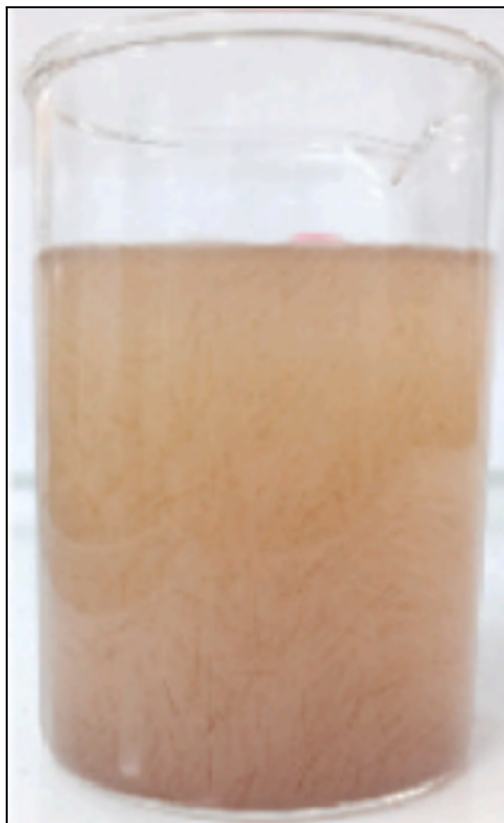
Figura 15 - Suspensão ideal de nanocristais a partir da hidrólise com ácido sulfúrico.
