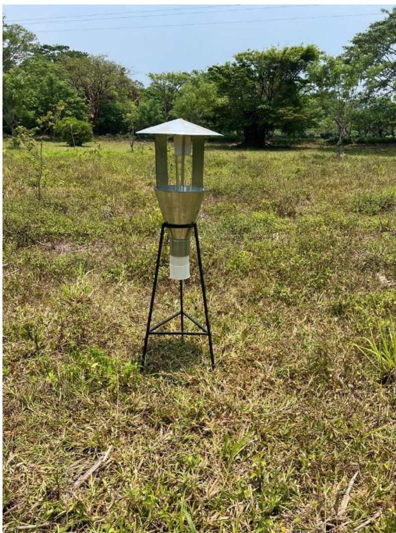
Figura 2 - Armadilha luminosa tipo "Luiz-de-Queiroz".
