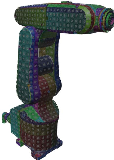
Figura 3.2: Mapeamento UV aplicado ao modelo 3D do robô Denso VP6242.
