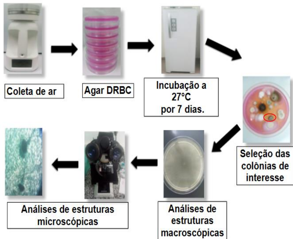
Figura 6. Esquema das etapas da metodologia para identificação dos aerossóis fúngicos coletados.
