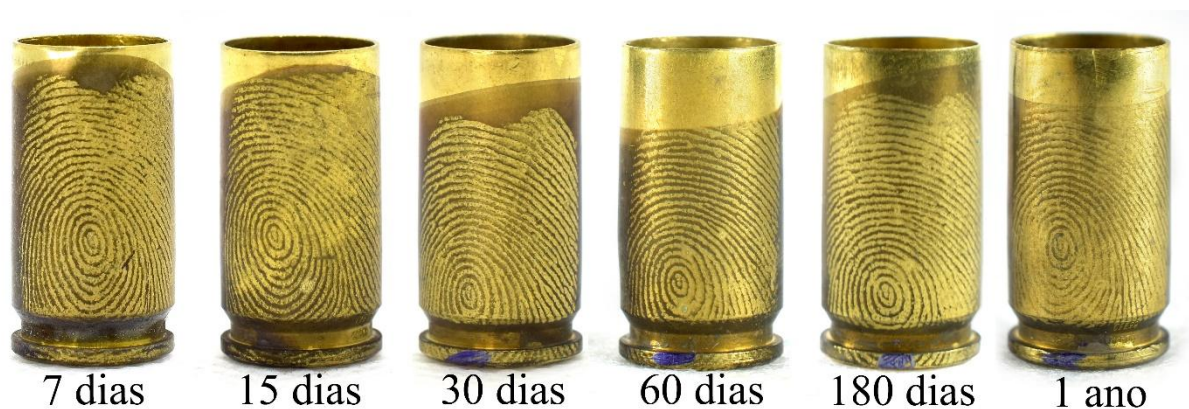
Figura 40 - Imagens representativas da revelação de impressões digitais latentes em estojos de munição calibre 9x19 mm através da eletrodeposição de Ag em amostras envelhecidas em 7, 15, 30, 60 dias, 180 dias e 1 ano.
