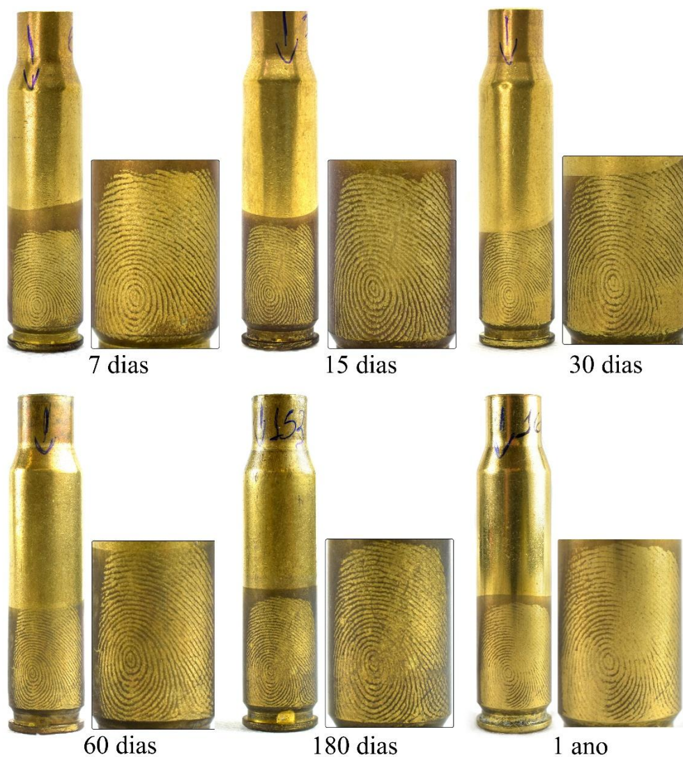
Figura 39 - Imagens representativas da revelação de impressões digitais latentes em estojos de munição calibre 7,62x51 mm através eletrodeposição de Ag em amostras envelhecidas em 7, 15, 30, 60 dias, 180 dias e 1 ano.
