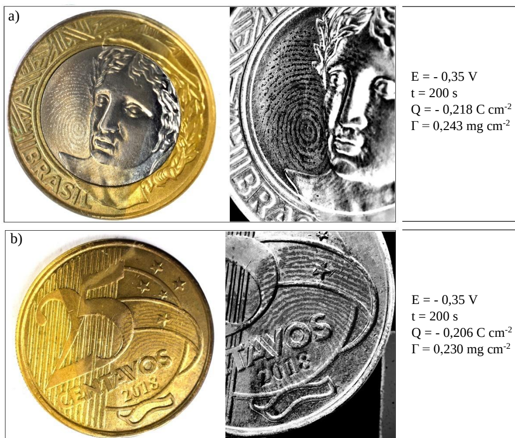
Figura 49 – Imagens e amplificação digital (em preto e branco) da revelação de IDLs de 15 dias por eletrodeposição de Ag em: a) moeda de 1 real brasileira (círculo interno: Cu, Ni, Sn e Ag, círculo externo: Cu e Ni); b) moeda de 25 centavos brasileira (Aço inoxidável revestido de Cu e Sn); e descrição das condições de E (potencial), t (tempo), Q (carga) e \Gamma (quantidade estimada de massa de Ag depositada).
