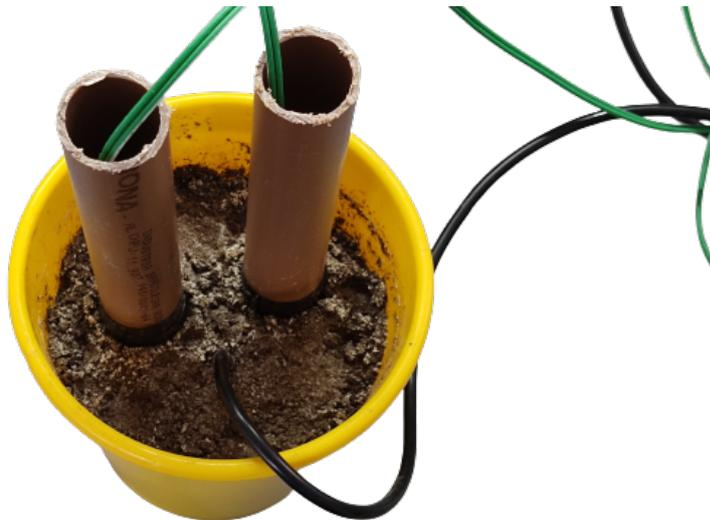
Figura 3.6: Sensor inserido em amostra de terra.
