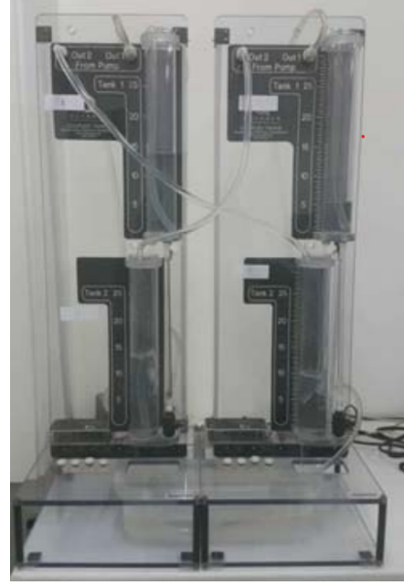
Figura 4.14: Sistema de Tanques Acoplado esquemático (à esquerda) e real (à direita).
