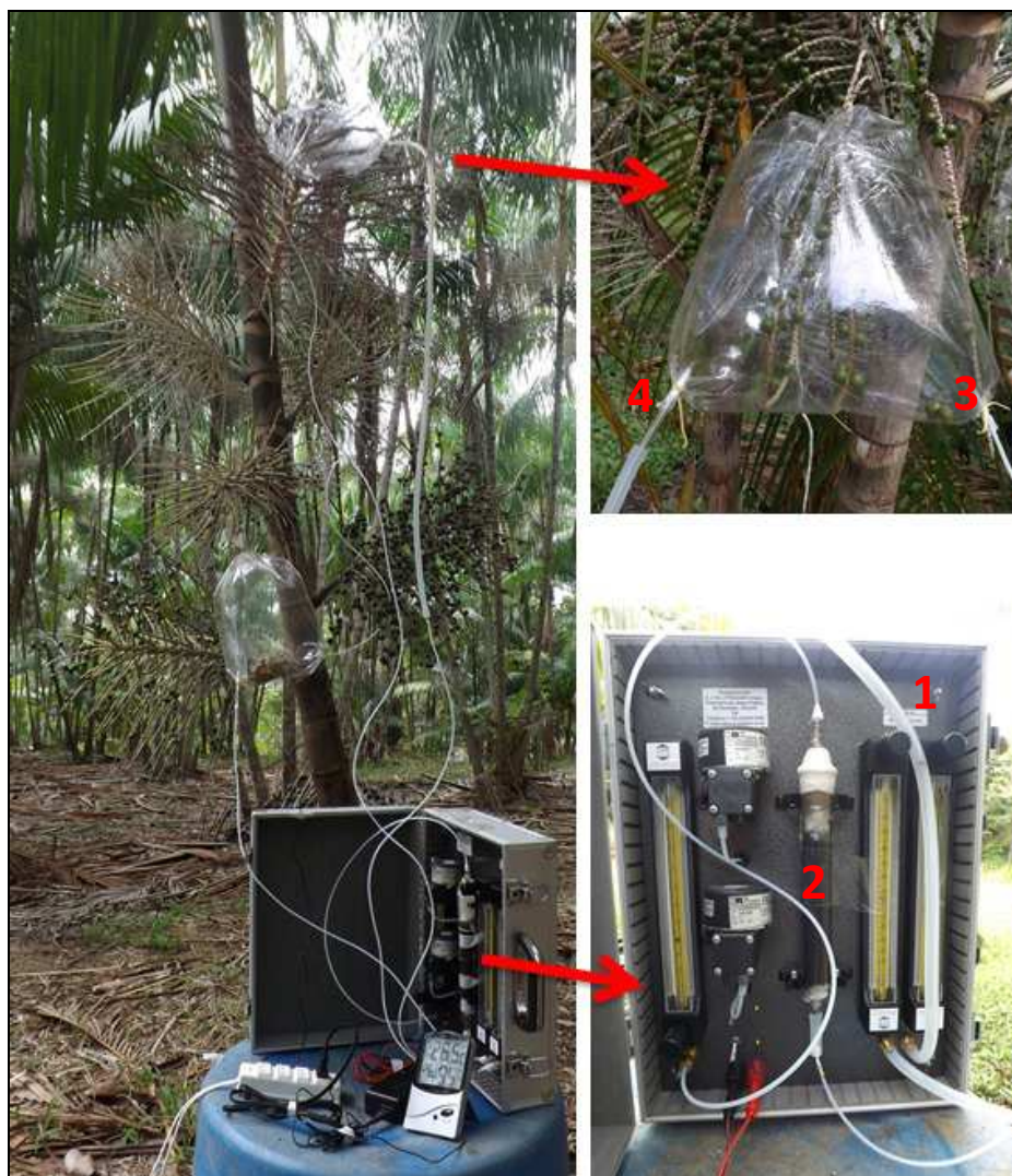
Figura 3. Sistema de aeração montado no campo. 1) Bomba de ar e vácuo; 2) Filtro de carvão; 3) entrada de ar e 4) Substância adsorvente. (Foto: Autor, 2013).
