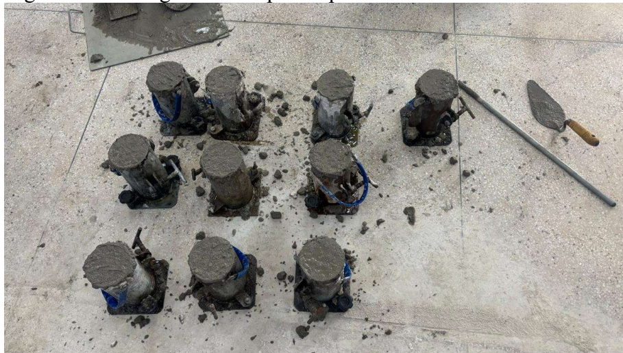
Figura 17: Moldagem dos corpos de prova
