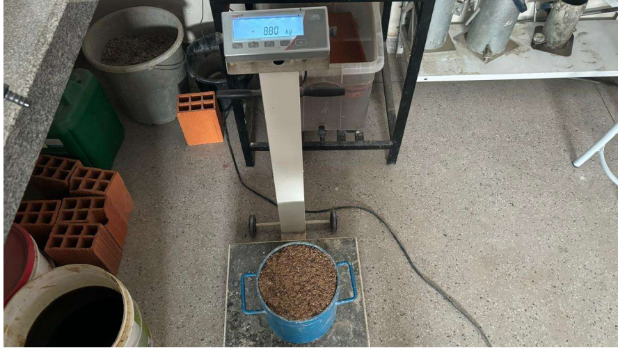
Figura 7: Amostra de areia no recipiente sendo pesada
