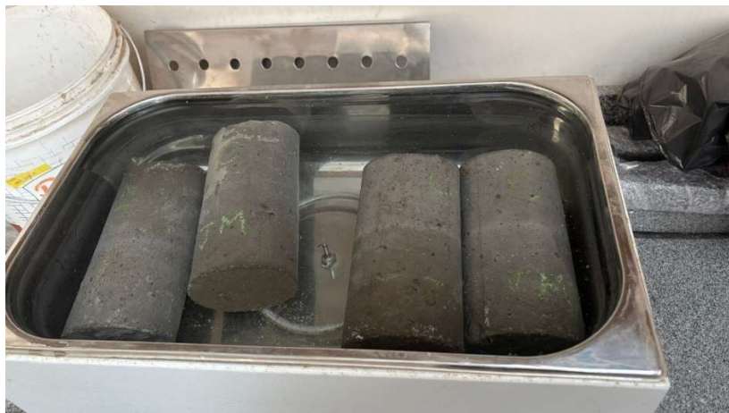
Figura 19: Processo de cozimento dos corpos de prova
