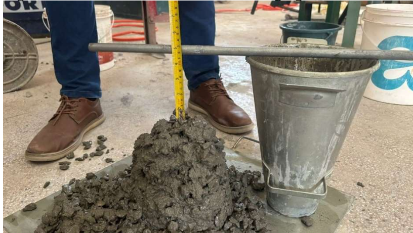
Figura 25: Abatimento do concreto com agregado lamelar
