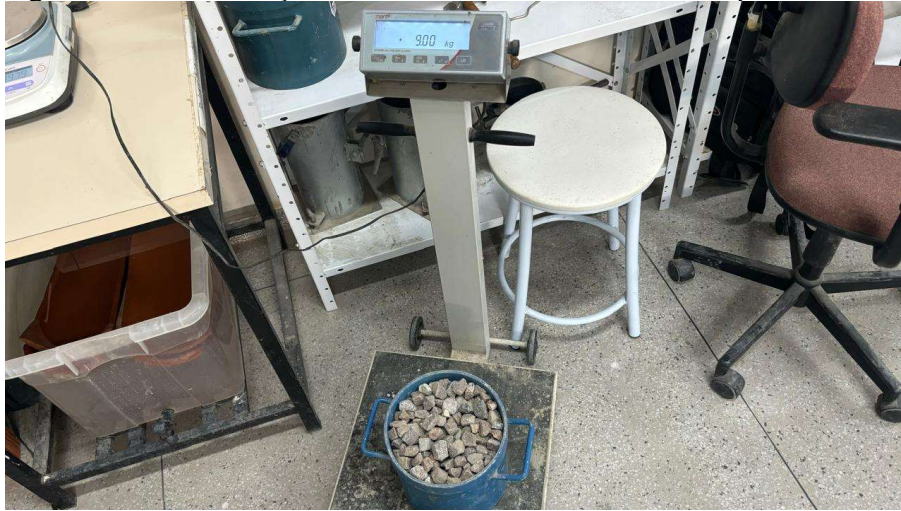
Figura 13: Determinação da massa da amostra com o recipiente
