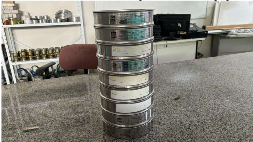
Figura 4: Peneiras utilizadas no ensaio de granulometria dos agregados miúdos
