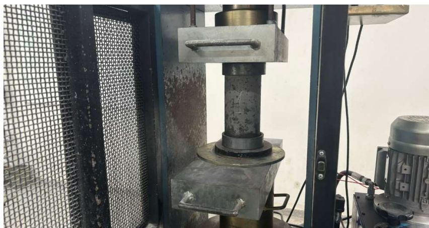
Figura 23: Rompimento dos corpos de prova
