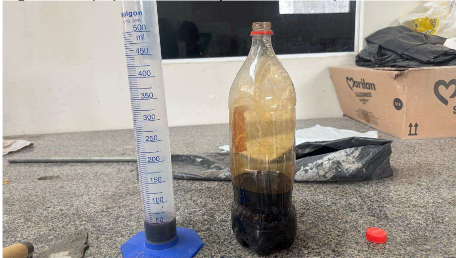
Figura 14: Superplastificante em processo de medição
