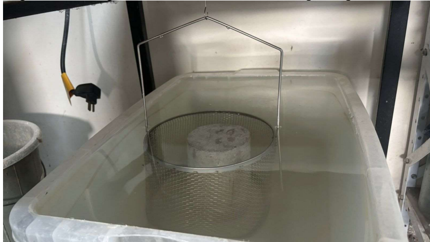
Figura 20: Pesagem da massa submersa do corpo de prova
