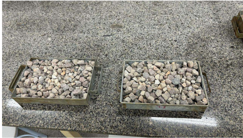
Figura 10: Amostras de agregados graúdos para realização do ensaio de granulometria
