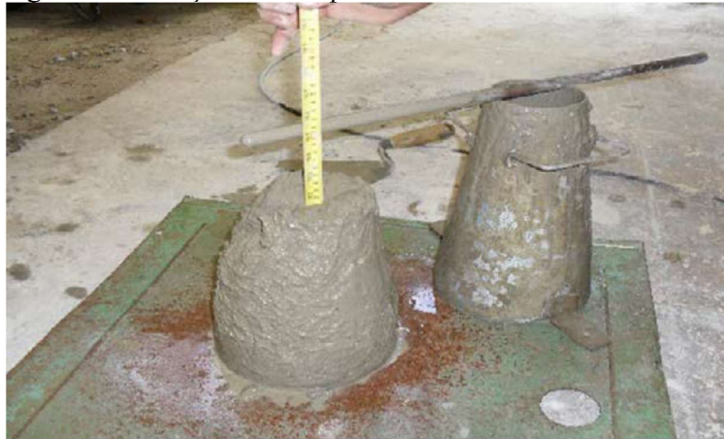
Figura 2: Execução do Slump Test
