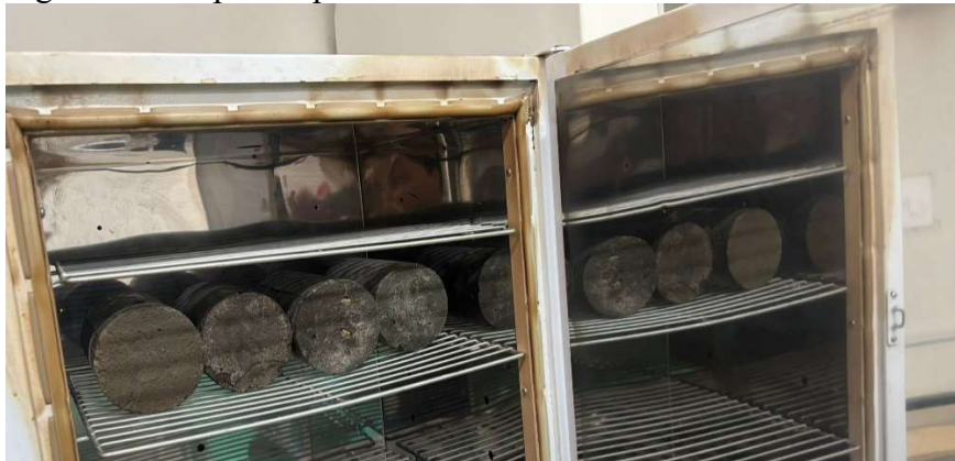
Figura 21: Corpos de prova na estufa
