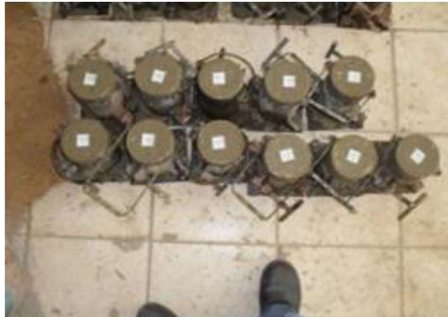
Figura 1: Processo de inserção de concreto nos moldes
