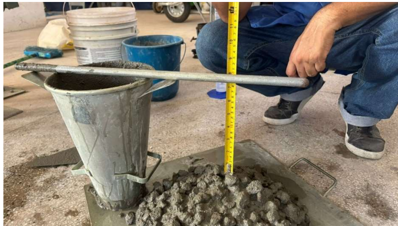
Figura 24: Abatimento do concreto com agregado cúbico
