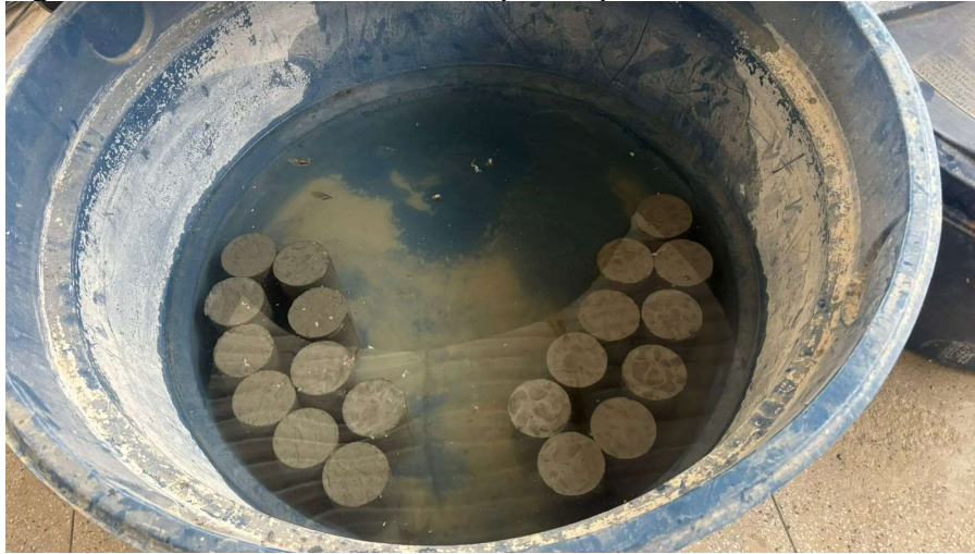
Figura 18: Processo de cura dos corpos de prova
