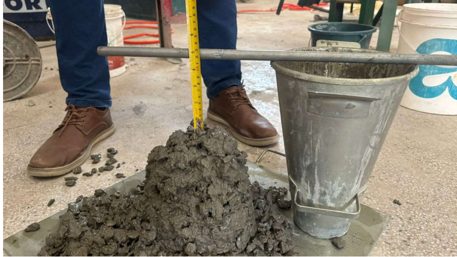
Figura 16: Medição do slump do concreto
