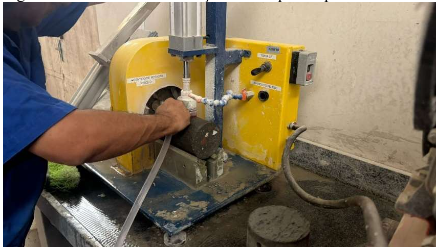
Figura 22: Processo de retificação dos corpos de prova
