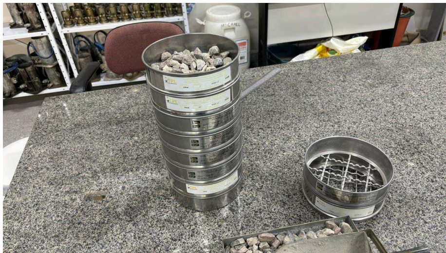
Figura 11: Peneiras utilizadas no ensaio de granulometria dos agregados graúdos
