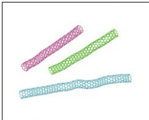
Figura 11 – Geometria dos nanotubos de carbono. Os nanotubos que possuem um diâmetro entre 7 e 15 nanômetros, e um comprimento de até 10 micrometros
