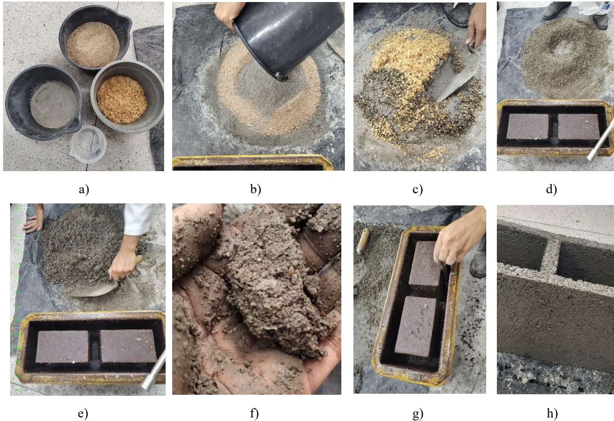
Figura 31 –Estudo do traço do bio-bloco com substituição de 2% de areia por serragem. a) Separação dos materiais, b) Mistura da areia com cimento e c) Adição da serragem saturada, d) Adição de água, e) Homogeneização dos componentes, f) Verificação tátil da consistência da mistura, g) Preenchimento da forma com compactação manual em camadas e h) desforma do bio-bloco.
