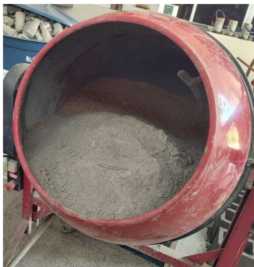
Figura 33 – Mistura da areia, cimento e serragem no preparo do traço 6. a) Mistura do cimento e areia até homogeneização e b) Adição da serragem.
