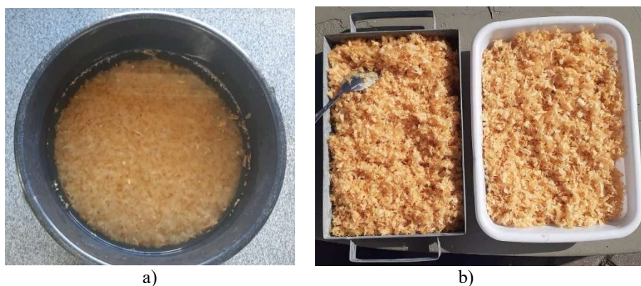
Figura 23 – a) Saturação do bio-agregado e b) secagem ao ar.
