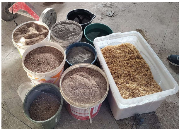
Figura 32 – Separação dos materiais para produção dos bio-blocos com substituição de 2% da massa de areia por serragem tratada com ciclos de cozimento em água a 80°C.
