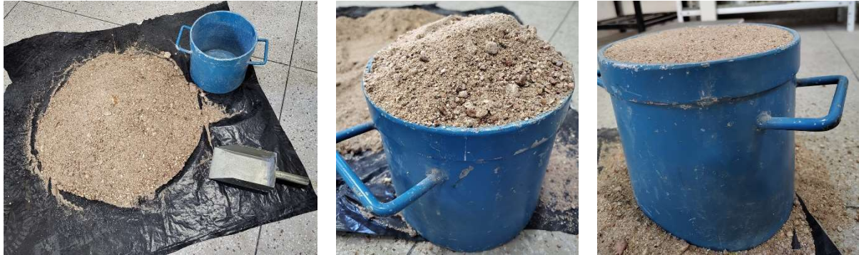
Figura 19 – Procedimentos laboratoriais para definição da massa unitária da areia. a) Materiais utilizados, b) Enchimento do recipiente e c) Nivelamento do recipiente.
