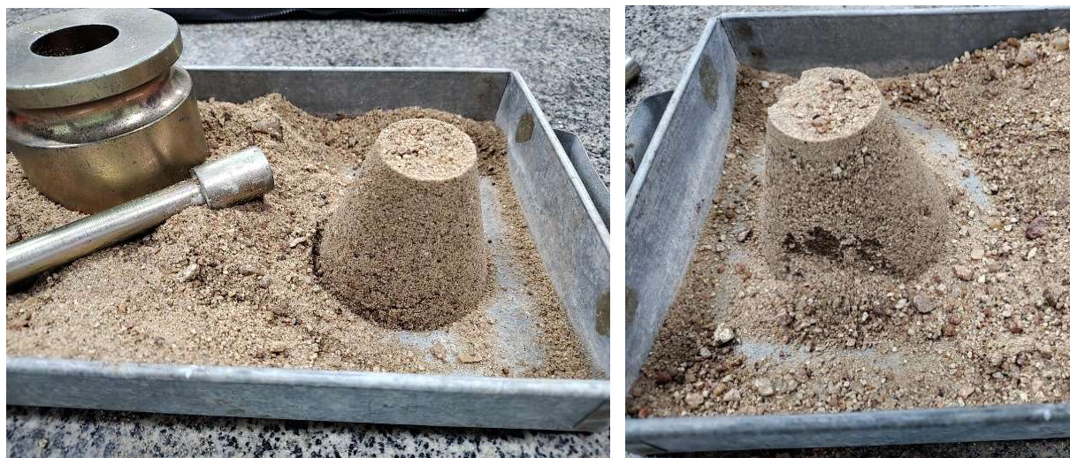
Figura 20 – Verificação do estado de saturação superfície seca do material. a) Amostra de areia ainda com água superficial e b) Partículas saturadas superfície seca.
