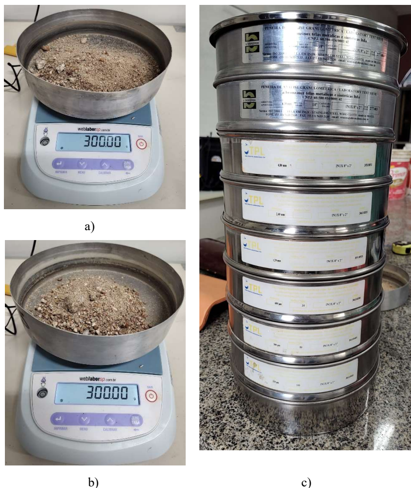
Figura 18 – Ensaio de granulometria da areia. a) Pesagem da amostra A, b) Pesagem da amostra B e c) Jogo de peneiras empregado no ensaio.
