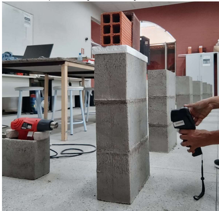
Figura 42 – Aferição da temperatura das paredes com câmera térmica.
