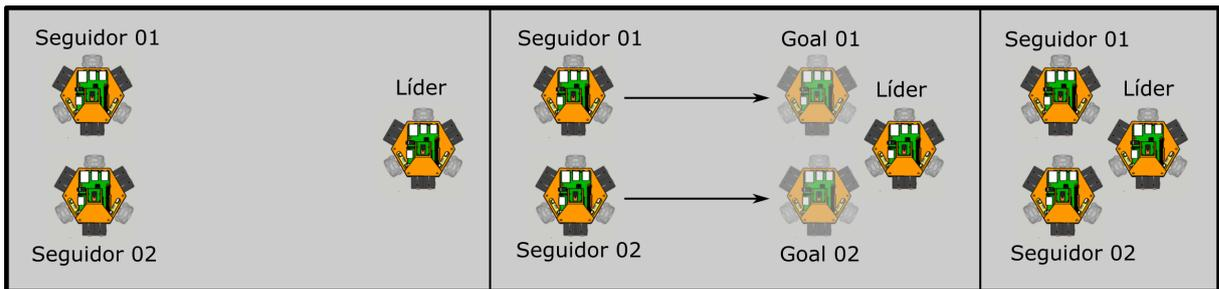
Figura 5.7: Formação por consenso: robôs fora de formação, robôs calculam o ponto de destino, robôs executam deslocamento.
