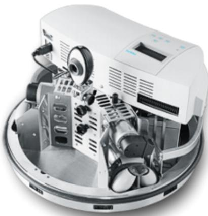
Figura 2.16: Plataforma Robotino
