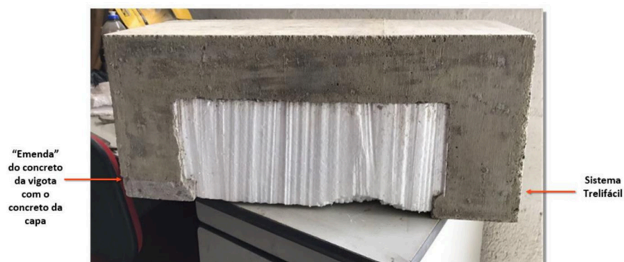
Figura 31: Comparação de concretagem entre treliça comum e Trelifácil®
