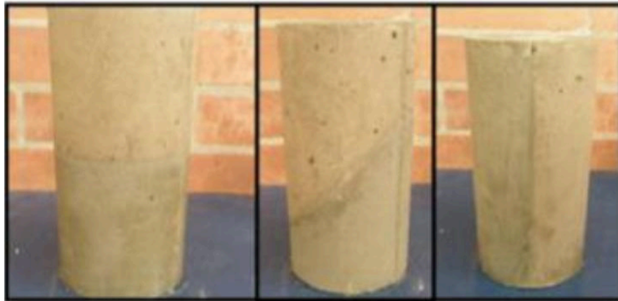
Figura 11: Corpos de prova com juntas frias horizontais, diagonais e verticais
