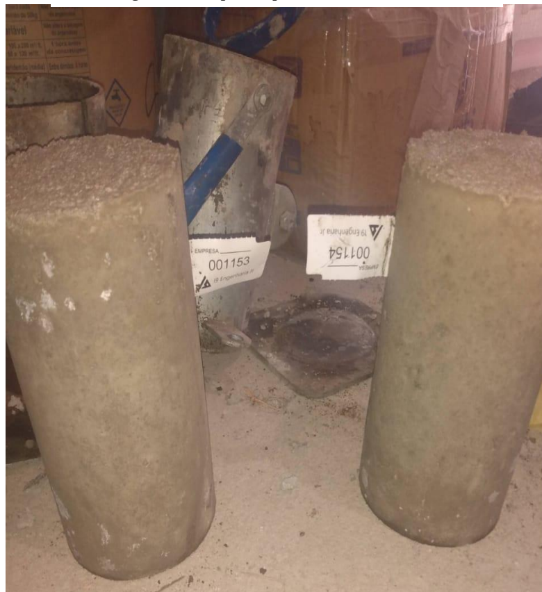
Figura 14- corpos de prova desenformados.
