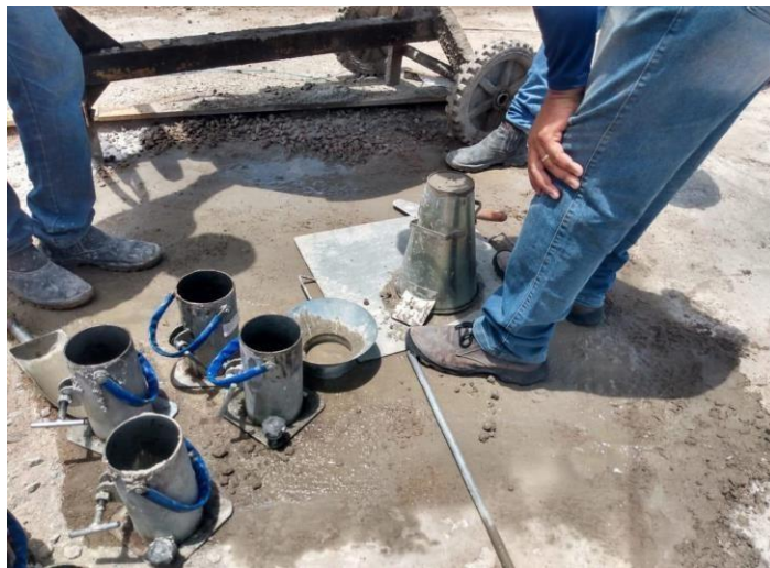
Figura 11- momento de retirar o cone no teste slump.
