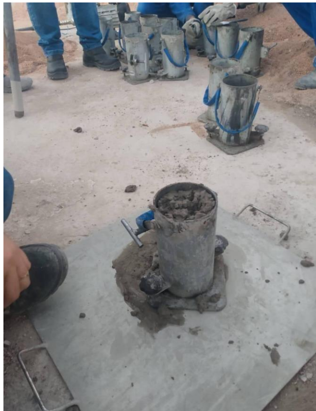
Figura 13 - moldagem dos corpos de prova
