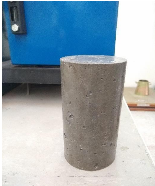
Figura 19- Corpo de prova no Laboratório para ser rompido.
