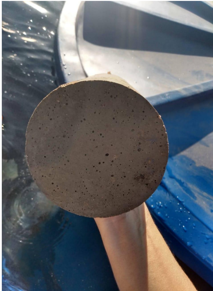
Figura 15- Corpos de prova sendo retirados da caixa d'água após a cura de 28 dias.
