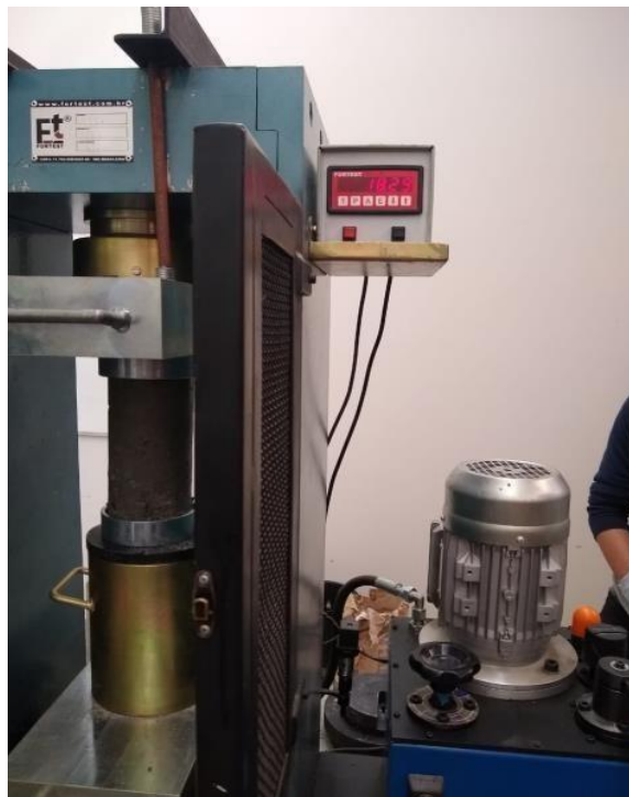
Figura 20- Rompimento de corpo de prova na prensa hidráulica.
