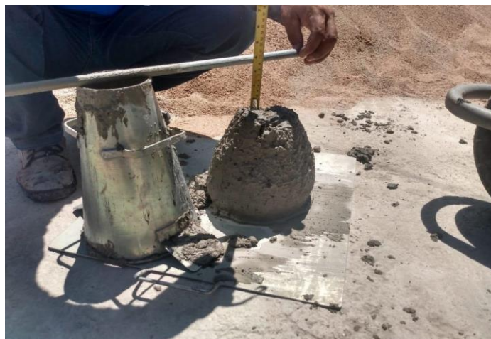
Figura 12- conferência da altura do teste slump na trena.
