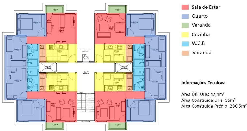
PLANTA BAIXA DE PAVIMENTO TIPO
