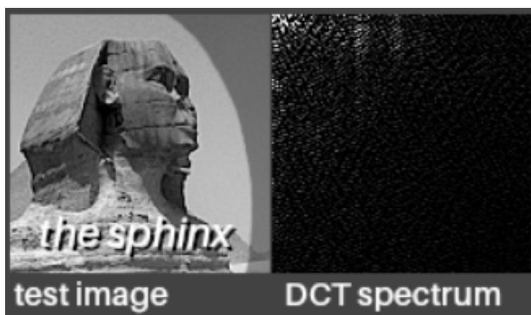
Figura 2.6: Imagem no domínio espacial na esquerda e sua versão no domínio de frequência por DCT. Imagem retirada de: [3]
