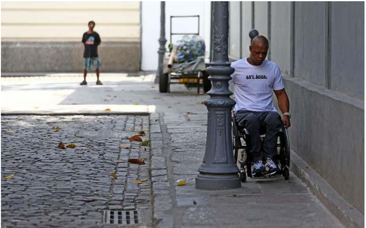
Figura 3 - Barreiras fixas (poste) na calçada
