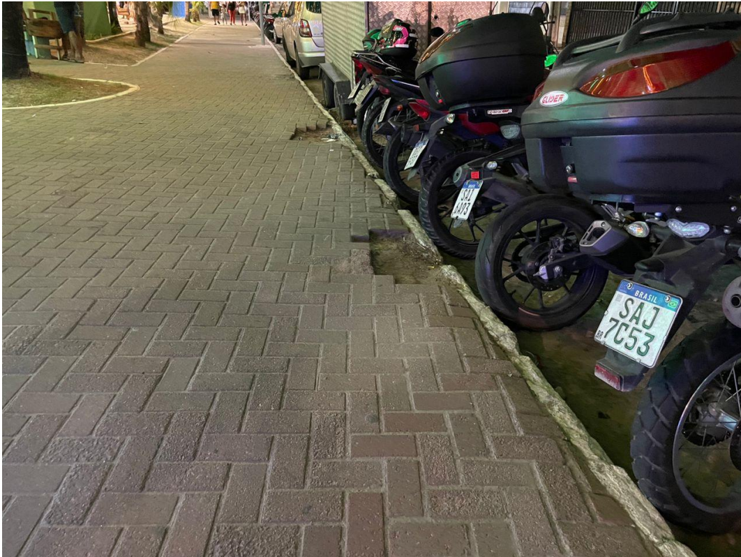
Figura 29 – Observa-se a barreira informativa na lixeira e a ausência de pisos direcionais e de alerta.
