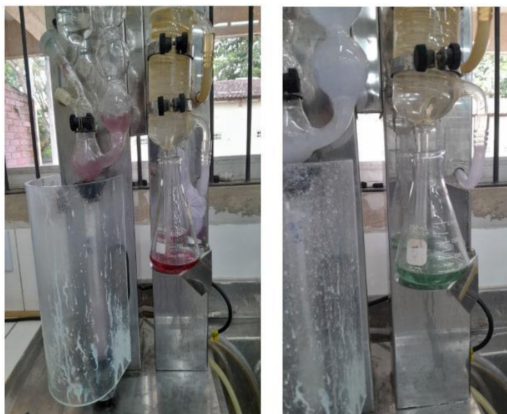
Figura 5: (a) início do processo de destilação com coloração rosa; (b) finalização do processo de destilação com coloração esverdeada.
