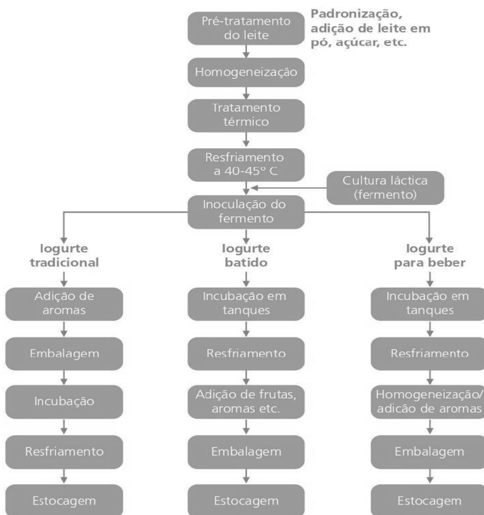
Figura 3: Fluxograma das operações no processamento de diferentes iogurtes.
