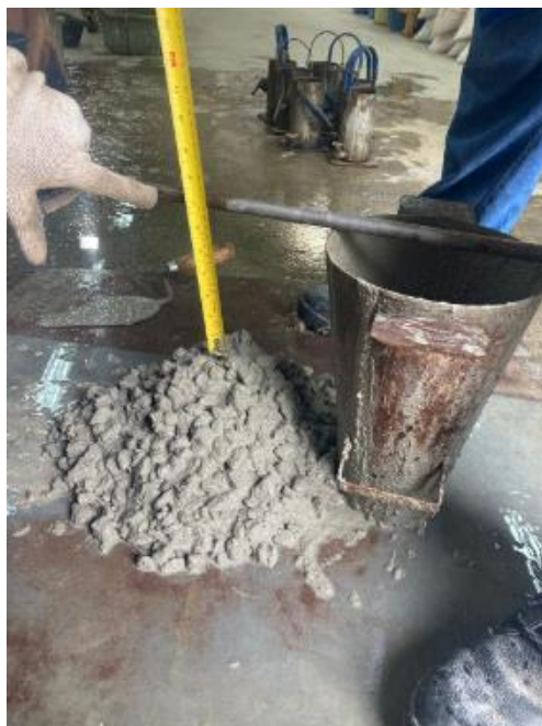
Figura 12 - Ensaio de abatimento do tronco de cone, com pré-molhagem do agregado saturado
