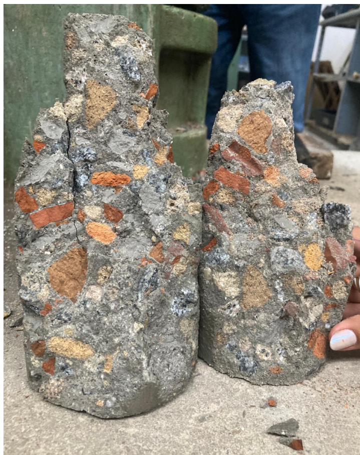
Figura 14 - Corpo de prova rompido
