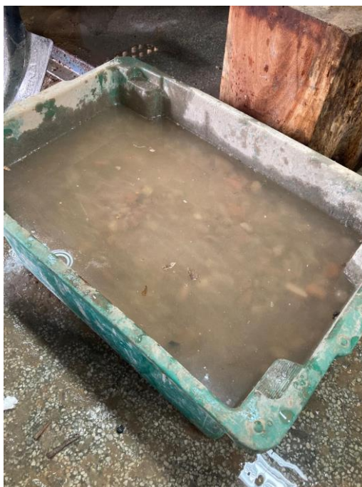
Figura 5 - Método de pré-molhagem com agregados submersos
