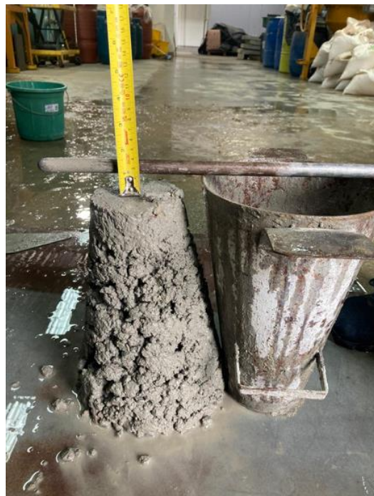
Figura 11 - Ensaio de abatimento do tronco de cone, com pré-molhagem equivalente a 100% de absorção
