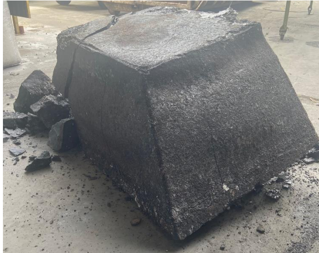
Figura 2 – Resíduo de escória da fundição.
