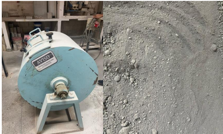
Figura 9 – Escória moída em moedor de bolas.
