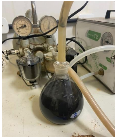
Figura 10 – Representação da extração de ar nas amostras por meio da bomba de vácuo.
