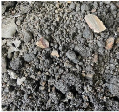
Figura 6 – Escória salina quebrada.
