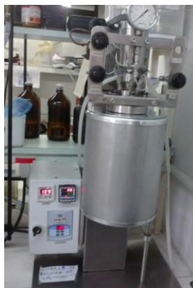
Figura 13 – Reator utilizado para a realização das reações de transesterificação.
