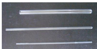
Figura 8 - Tubos apropriados para diferentes tipos de sonda e experimentos de RMN.
