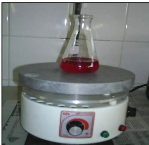
Figura 25. Ponto de Equivalência ou Ponto Final da Titulação.
