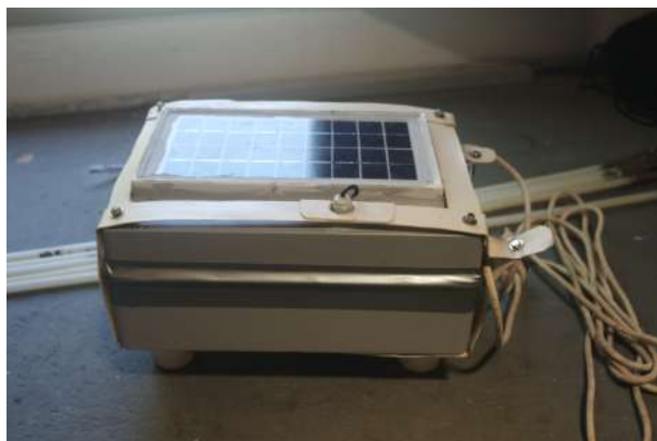
Figura 6.9 - Vedação entre a tampa e a caixa
