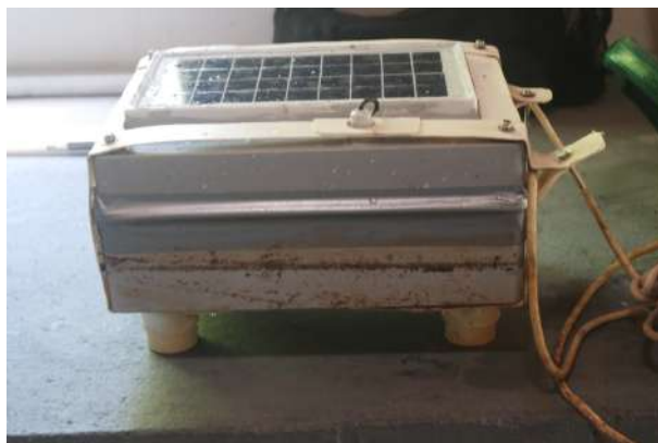
Figura 6.10 - Acúmulo de matéria orgânica no datalogger
