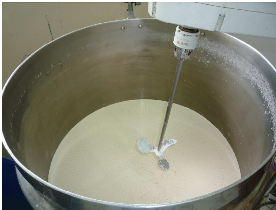
**Figura 12. Lama retida no tanque de coagulação**
