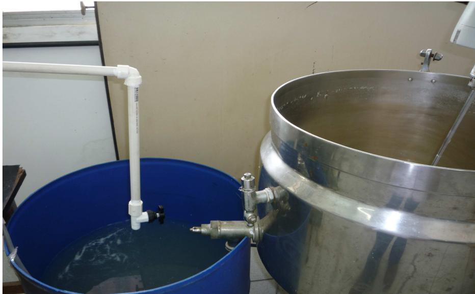
**Figura 11. Transferência do efluente após coagulação**
