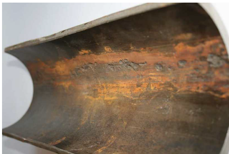
Figura 2.20 – Corrosão CO 2 por pites observada em tubo 13Cr.
