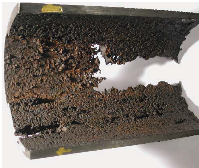
Figura 2.19 – Corrosão severa observada em pequeno tubo em poço no campo de Troll, na Noruega.
