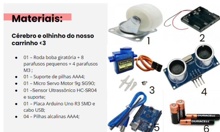
Figura 78 – Materiais para montagem da "Larissinha": cérebro e olhinho do nosso carrinho.
