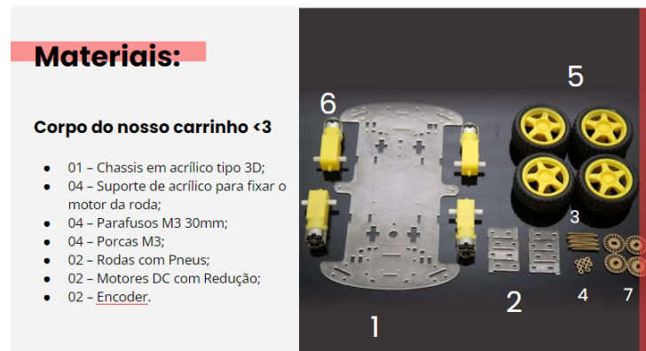
Figura 77 – Materiais para montagem da "Larissinha": o corpo do carrinho.
