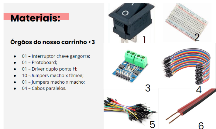
Figura 79 – Materiais para montagem da "Larissinha": órgãos do nosso carrinho parte 1.
