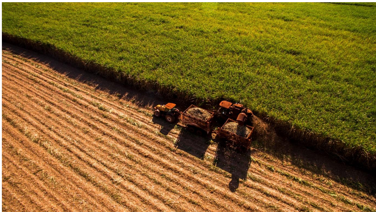
Figura 1 - Colheitadeira automatizada com navegação por GPS RTK acompanhado por trator puxando chassis de carga.
