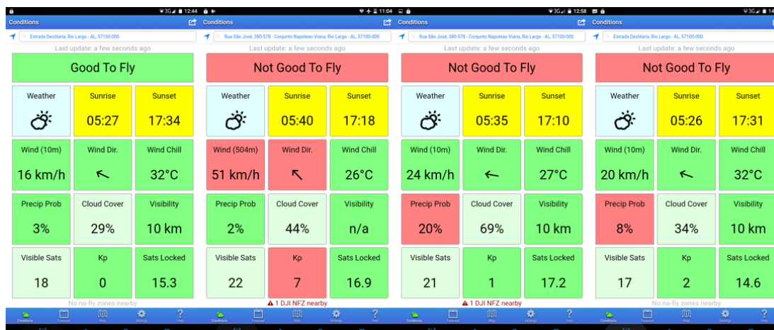
Figura 11. Das várias capturas de tela do tablet utilizado no projeto, dentro do aplicativo UAV Forecast , em dias e épocas diferentes, com distancias variando entre 1.500 metros a 200 metros do local onde seria iniciado os trabalhos de tomada de fotos no Campus de Engenharias e Ciências Agrárias de Alagoas – CECA / UFAL.
